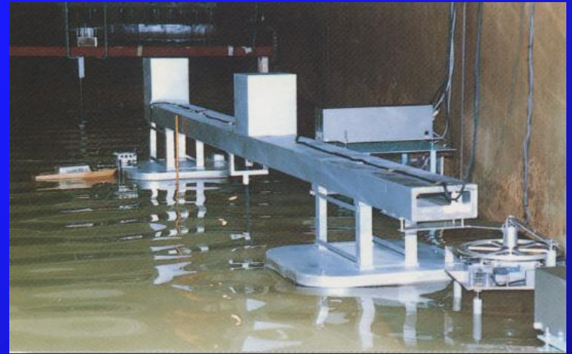
旋回および仮係留実験
